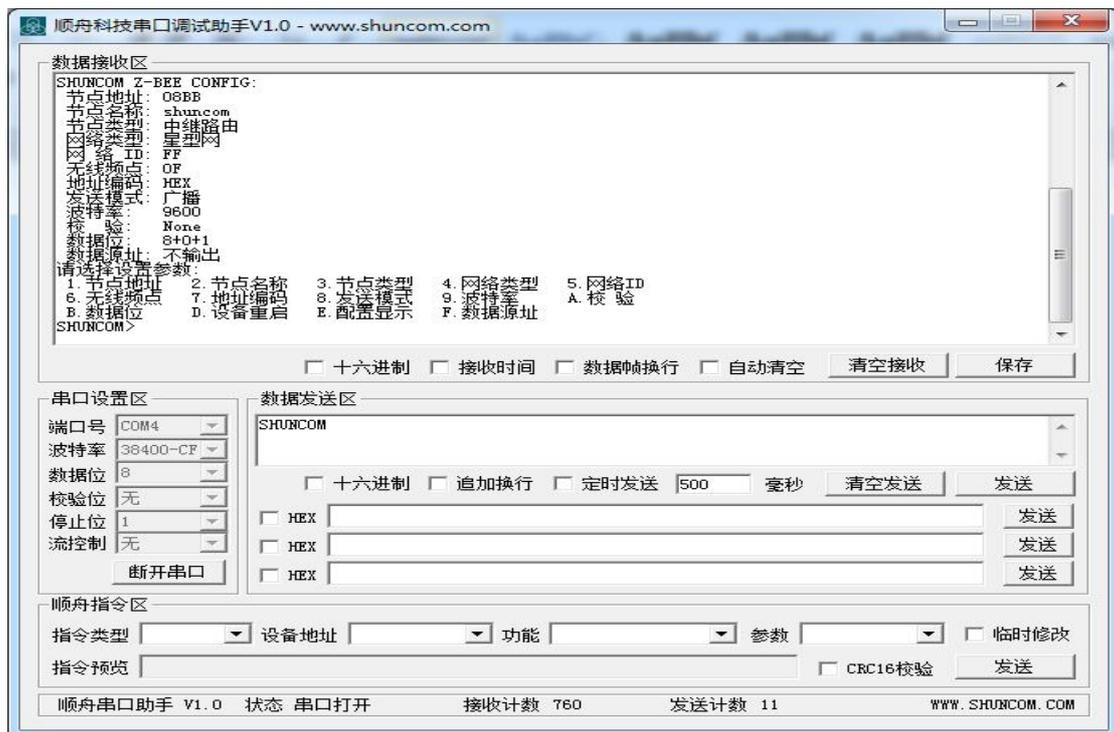
7、工具会自动显示出配置参数，如需修改参数设置，输入参数选项前的编号，再输入参数，即可修改成功。
