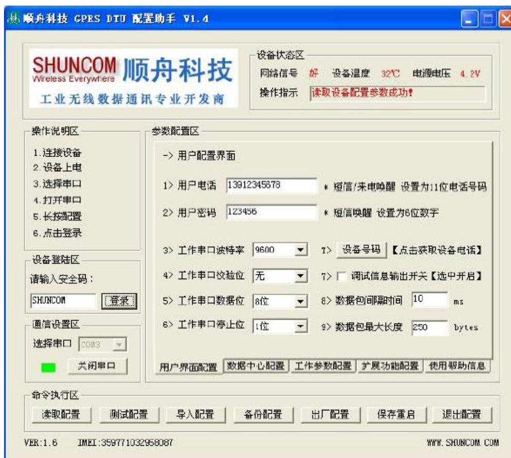
5、读取参数成功后，即可在空白参数区修改配置，配置修改完成后，单击保存重启，即可完成配置。
