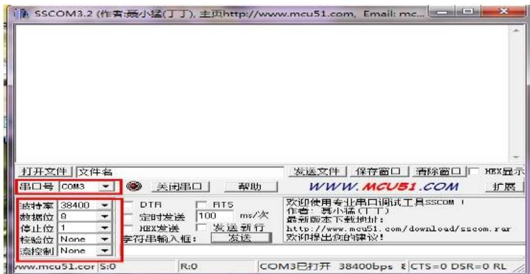
串口号：请选择正确的模块所对应的串口号。串选择错了，（界面没有任何显示）。
